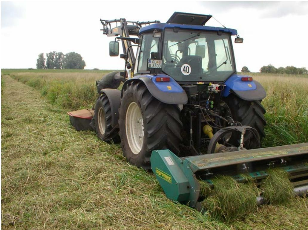
Abbildung 2 : Maschinenkombination Frontmäher und Heckmulcher – Mähmulchen
