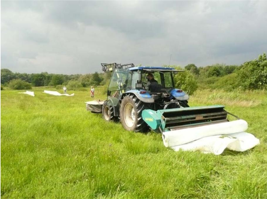
Abbildung 8 : Im Vorhaben entwickelter Anbau-Folienabwickler
