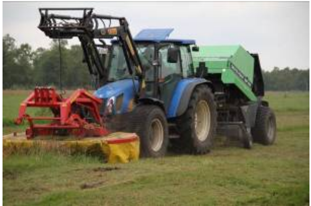
Abbildung 7 : Kombination Mähen – Aufbereiten - Pressen
