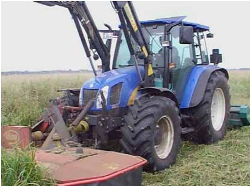
**Abbildung 5: Oben: Traktor mit Kreiselmäher (vorne) und Mulcher (hinten).**
